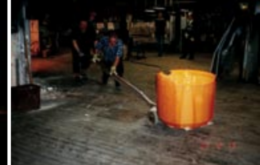
Den heta degeln har tjänat ut och ersätts av en ny.
