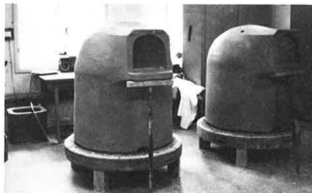
Här syns snabeln före och efter det leran skurits ut, samt bryggan vid anfangshålet
